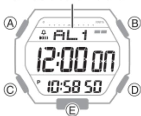
1. Presione (D) para desplazarse a través de las pantallas de los números de alarma ([AL1] a [AL5]) y de la señal horaria ([SIG]) hasta que aparezca la pantalla que desea configurar.
