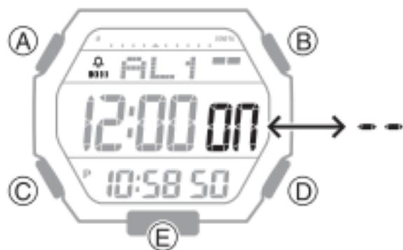
2. Presione (E) para activar o desactivar la alarma o la señal horaria visualizada.
