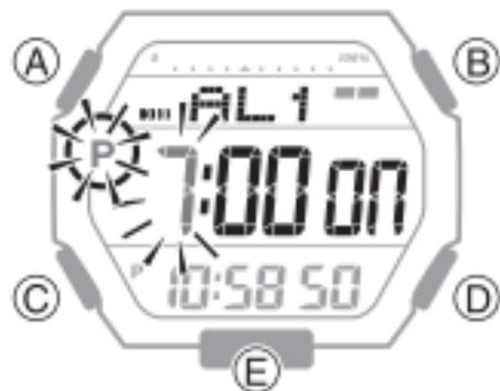
3. Utilice (D) y (E) para cambiar el ajuste de la hora.
