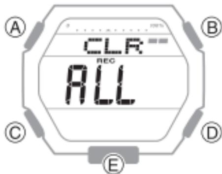
Puede realizar el procedimiento que se indica a continuación para borrar todos los registros de datos de vuelta/fracción almacenados en la memoria del reloj.
